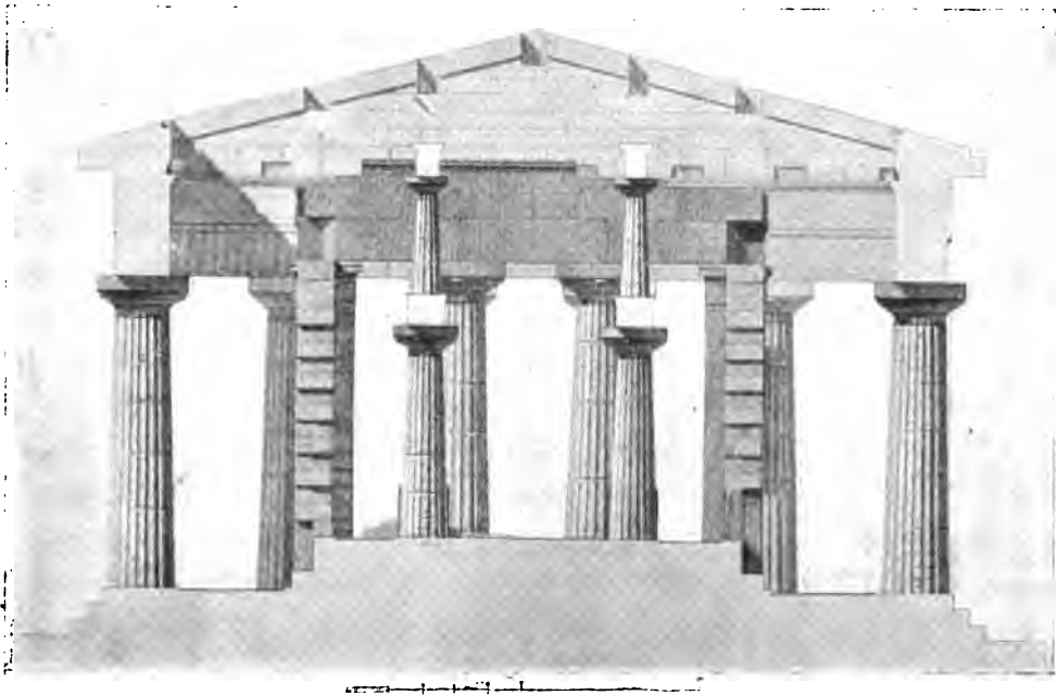
LE TEMPLE DE POSÉIDON A PÆSTUM ELEVATION (ÉTAT ACTUEL) ET COUPE TRANSVERSALE
